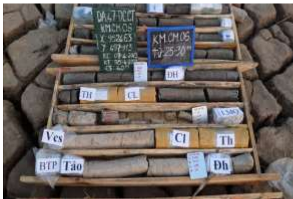
Ảnh: Mẫu lõi khoan máy Dự án 47-ĐCCT thi công khu vực điều tra trọng điểm Cà Mau
